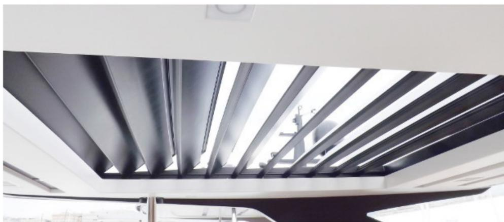
L'elemento centrale di questa nuova produzione Opac sta nella possibilità di **coniugare una notevole robustezza e rigidità con il movimento delle lamelle**. In questo modo, il tettuccio aperto diventa un normale hard top mentre da chiuso è **in grado di sostenere un peso utile a ospitare i passeggeri**. Naturalmente, per ogni progetto e tipologia di imbarcazione e di conseguenza per le diverse dimensioni della capote, Opac definisce l'**esatto carico massimo di peso che l'area può sopportare**.
